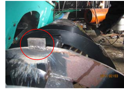
修理が完了したオーガの歯(上写真○枠内)。
