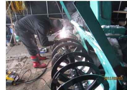
長年使用すると歯の「出っ張り」部分が磨耗します。
