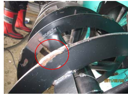
長年使用すると歯の「出っ張り」部分が磨耗します。
