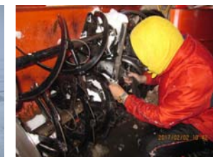
除雪機のオーガの修理作業(2月2日)
