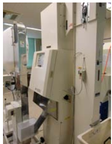
精米システムの各機械～小米取り機(左)着色米を取り除く色選機(中)計量機(右)(2月14日撮影)日本穀物検定協会が発表した2015年産米の食味ランキングにおいて、「ふっくりんこ」が正式に特Aランクを獲得。これで道産米の特Aは、3品種になりました。
