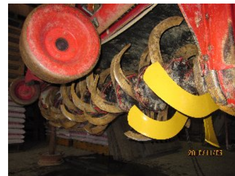
こちらは105馬力～作業効率の向上を狙って黄色い刃を新たに取付けました。
