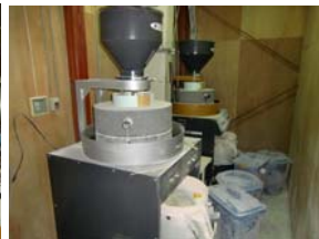
そば製粉用の選別機(左)と皮むき機(中)、石臼製粉機(右)～これらは全て隣町の専門業者の機械です(10月27日)
