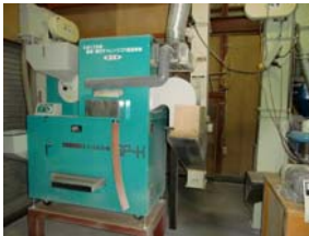
そば製粉用の選別機(左)と皮むき機(中)、石臼製粉機(右)～これらは全て隣町の専門業者の機械です(10月27日)
