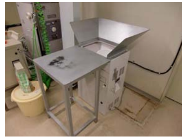
①石抜き機～石などの異物を除去します
